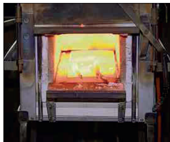
Auf um die 1000 Grad Celsius wird das Metall erhitzt, bevor es bearbeitet werden kann.
