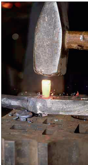
Glühend heiß muss das Metall sein, damit der Nagel seinen Kopf erhält.
